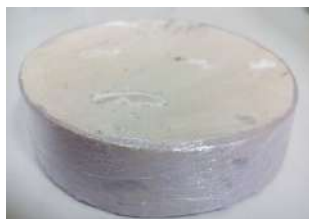
Figure. 1. Echantillon cylindrique de Cématerre pour l'essai de la coupelle « Mesure de la perméabilité à la vapeur »
